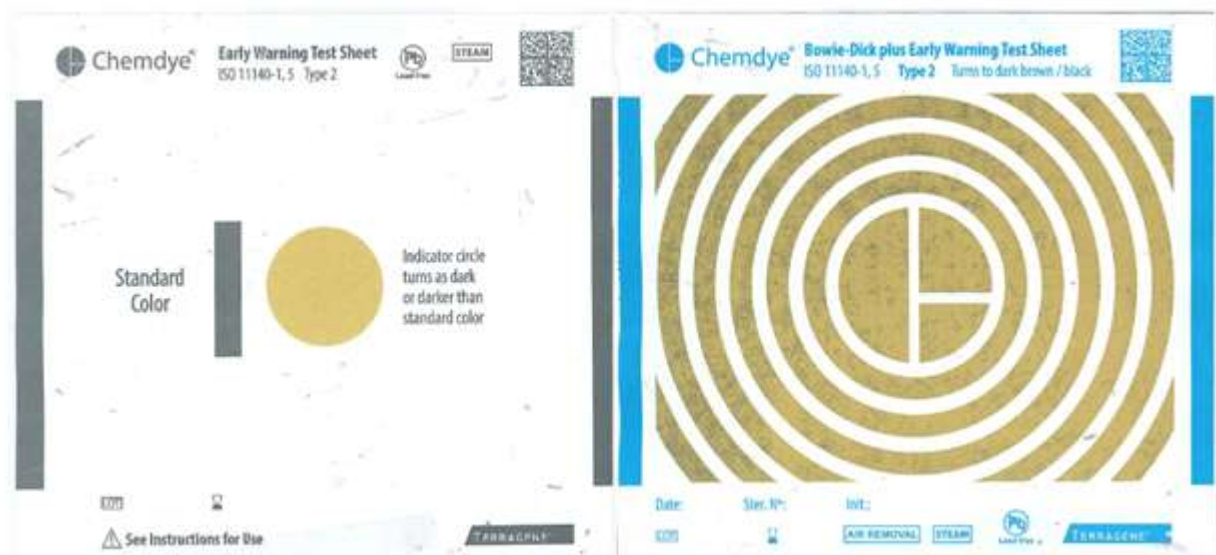
Figura 7. Indicadores de prueba Bowie & Dick después de la exposición a calor seco 30 minutos a 140 ° C.
