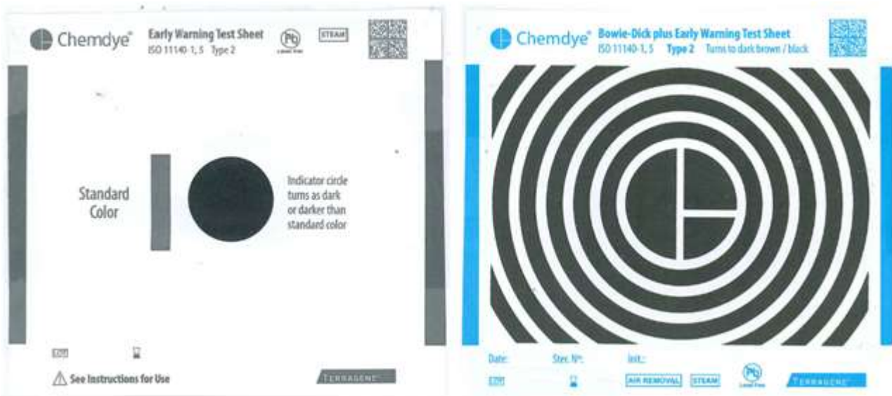
Figura 3. Chemdye® BD125X/1 después de la exposición a tres pulsos de vacío, ciclo de Bowie Dick 3,5 min a 134°C.
