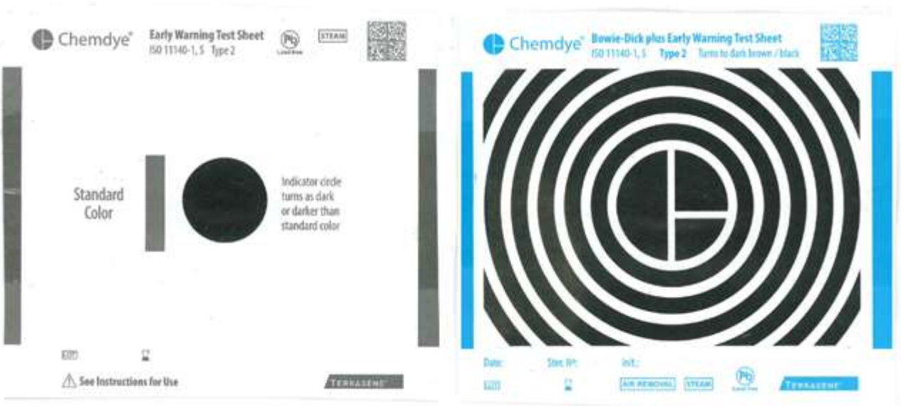
Figura 5. Chemdye® BD125X/1 después de la exposición a tres pulsos de vacío, ciclo Bowie Dick 4 min a 132°C.
