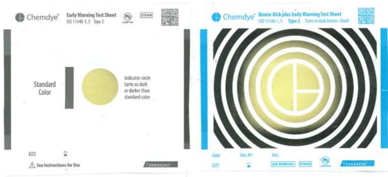
Figura 4. Chemdye® BD125X/1 después de la exposición a un pulso de vacío, ciclo Bowie Dick 3,5 min a 134°C.
