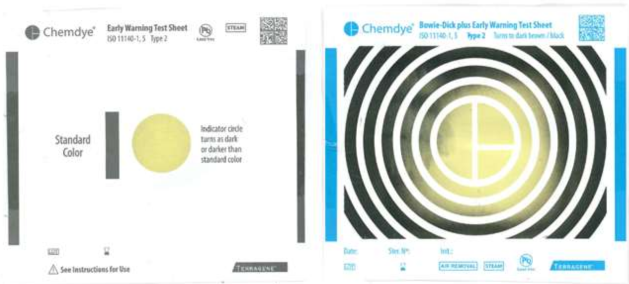
Figura 6. Chemdye® BD125X/1 después de la exposición a un pulso de vacío, ciclo BD 3,5 min a 134°C.
